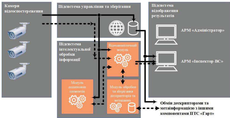
Рис. 2. Блок-схема архітектури програмно-технічного комплексу концептуальної інтелектуальної системи відеоспостереження ДПСУ
